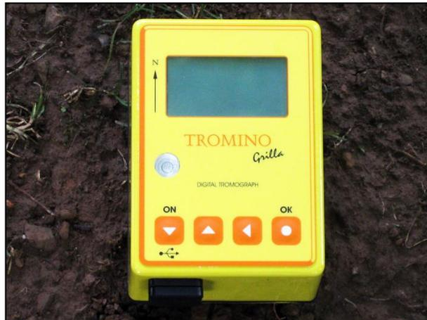
**Figura 8** – Esecuzione di una registrazione del microtremore sismico con Tromino MICROMED di proprietà della Geosism.
