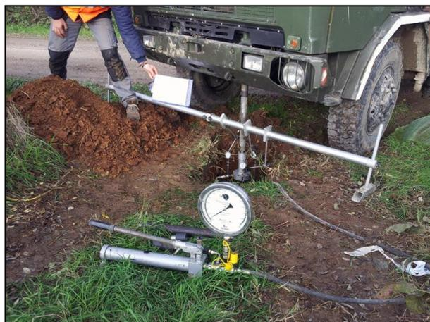
**Figura 4** – Esecuzione di una prova di carico su piastra.
