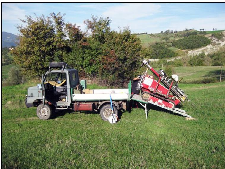
**Figura 1** – Penetrometro statico/dinamico Pagani TG63 200KN scaricato da autocarro Bremach di proprietà della Geosism.
