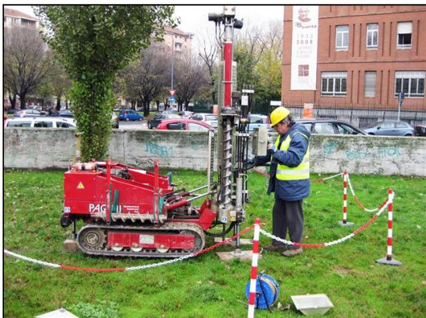
**Figura 3** – Esecuzione di una prova penetrometrica (statico/dinamica) con penetrometro Pagani TG63 200KN di proprietà della Geosism.
