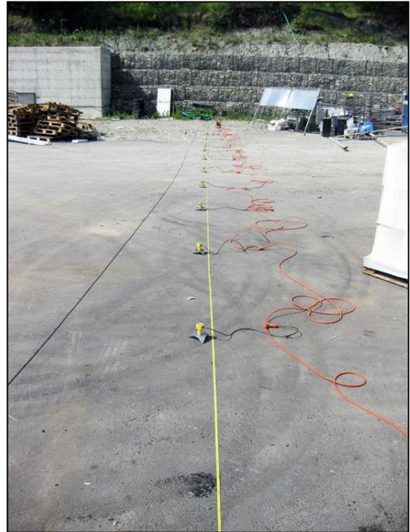
**Figura 7** – Esecuzione di una prova sismica MASW su superficie lastricata o osfaltata con sismografo PASI di proprietà della Geosism.
