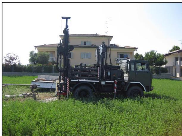
**Figura 5** – Esecuzione di un carotaggio continuo con prelievo di carote e campioni indisturbati.
