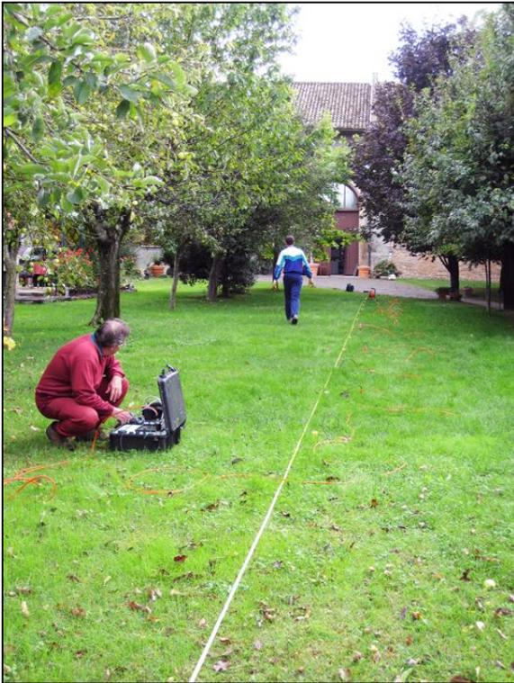
**Figura 6** – Esecuzione di una prova sismica MASW su terreno naturale con sismografo PASI di proprietà della Geosism.
